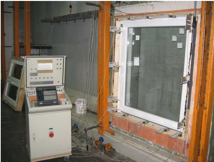
Bild 8 Ansicht Probekörper mit angebrachten Messstellen
